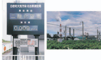
図2: 当時の大昭和製紙工場と、その真向いに設置されている365日・24時間連続測定の大気汚染監視装置。
